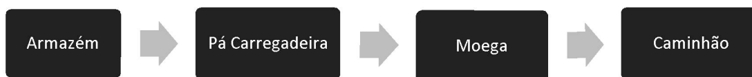
Figura 2 – Fluxograma da operação de expedição de sal e fertilizantes Fonte: Plano Mestre do Porto de Santos (2017)
